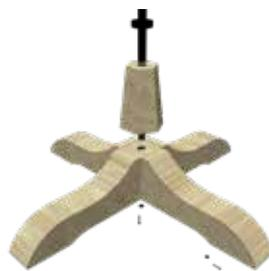
4. Schiebe den Stab durch die Teile.
